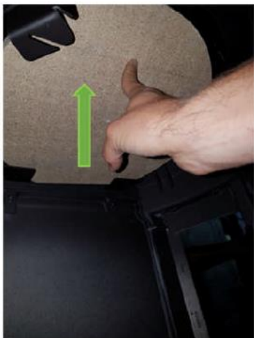
Skyv lett på brennplaten og anbring beslaget
